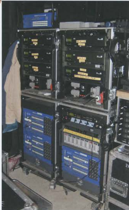
Racks neben der Bühne. Unten die drei Input Splitter, oben links ein I/O-Modul
