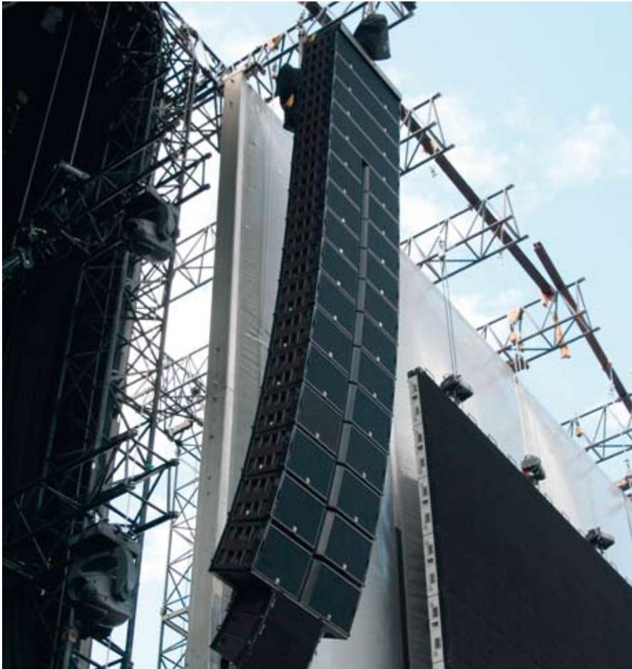
Zwölf K1-Module, vier K1-Subs und dreimal dVDOSC: Fertig ist die Banane
